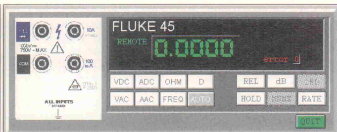
Bild 2: Als Treiber vorgefertigt – das Panel eines 'virtuellen' Meßgerätes.
