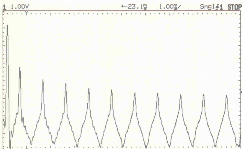
Bild 3. Bei Bedarf macht das C50-Board per Software aus einem Scope einen einfachen Spektrumanalysator, hier verarbeitete es ein Rechtecksignal.
